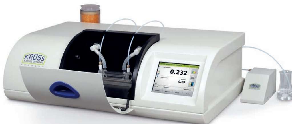
Inyección de muestras semi-automática con P8000-TF y bomba peristáltica DS7070
